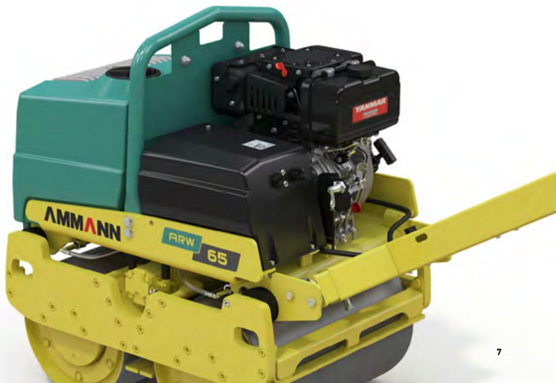
« Un grand réservoir d'eau de 60l, un racleur et un système d'arrosage sont installés par défaut. Ainsi, la machine est toujours prête pour une utilisation sur l'enrobé frais. »
