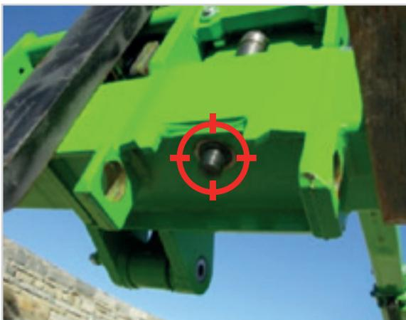
Tac-Lock : système de blocage hydraulique de l'équipement depuis la cabine en standard.
