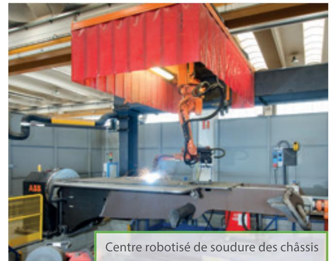
Centre robotisé de soudure des châssis
