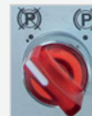
Sélecteur du frein de stationnement manuel activé automatiquement à la coupure du moteur.
