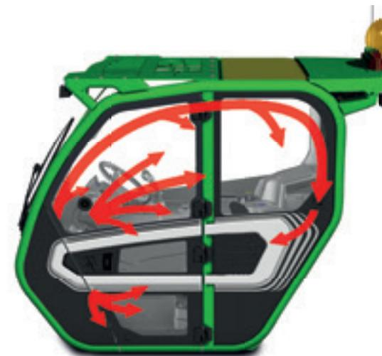
Le flux d'air est réparti de façon homogène à l'intérieur de l'habitacle et atteint de façon optimale toute les zones
