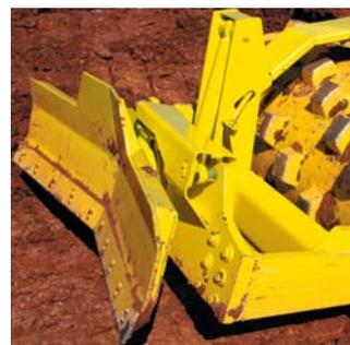
Lame niveleuse avec fonction tilt (RW 3005-SPT)
