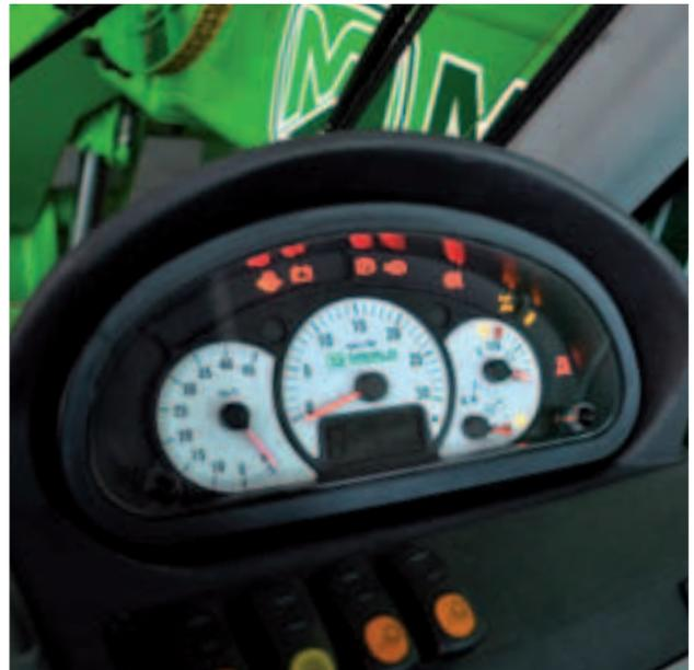
◀◀ Le **tableau des instruments** présente les principaux paramètres de travail et inclut l'**indicateur lumineux et sonore de stabilité** de la machine. A gauche, le pupitre de la série 38ST, ci-dessus celui de la série 40ST.
