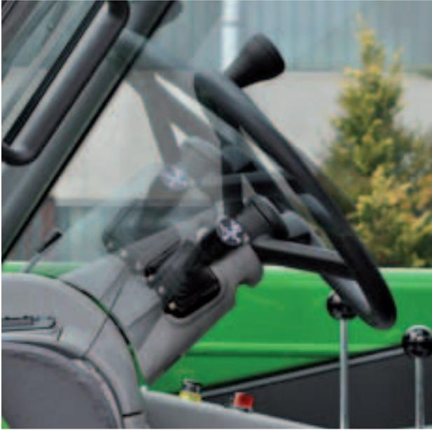
▲ L'**inclinaison du volant** est réglable jusqu'à 16 degrés afin de s'adapter aux différentes exigences de conduite.
