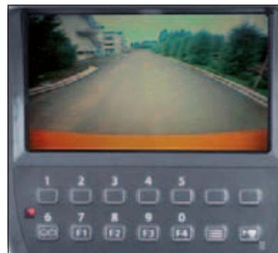
Le grand écran couleur LCD, combiné à la rétro-caméra sur le contrepois, fournit une vue pratique que la zone à l'arrière de l'unité. La caméra arrière fonctionne automatiquement en marche arrière et elle peut être activée manuellement à l'aide d'un sélecteur sur le moniteur.
