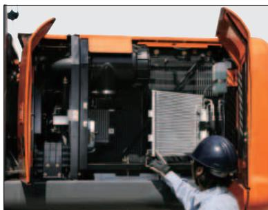
Le refroidisseur d'huile, le radiateur et l'échangeur sont disposés en parallèle au lieu de l'installation conventionnelle en série. Cette disposition en parallèle facilite considérablement le nettoyage autour du moteur. Le condenseur du climatiseur s'ouvre pour permettre de nettoyer facilement le condenseur et le radiateur placé derrière.
