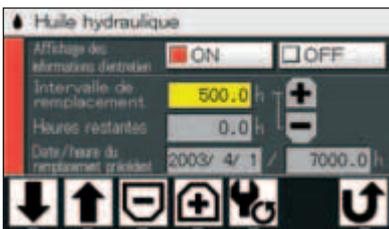
L'écran LCD alerte l'opérateur s'il faut changer l'huile hydraulique et les filtres de carburant selon le planning déterminé par l'utilisateur, à chaque fois qu'il tourne la clé de contact. La maintenance programmée peut éviter la panne de votre engin.
