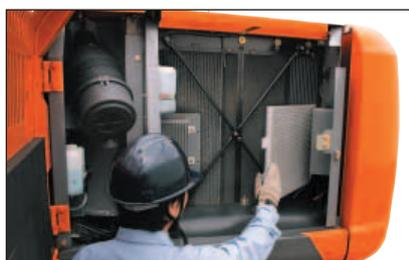
Le refroidisseur d'huile, le radiateur et l'intercooler sont maintenant disposés en parallèle et non plus en ligne, qui était la disposition conventionnelle. Cette disposition en parallèle facilite considérablement le nettoyage autour du moteur. Le condenseur du climatiseur s'ouvre pour en permettre un nettoyage aisé, ainsi que du radiateur placé derrière.
