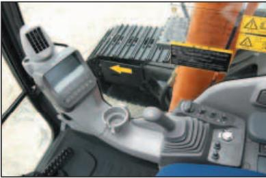
L'écran couleur à cristaux liquide situé dans la cabine indique la température du liquide de refroidissement, le niveau de carburant et les données d'entretien. Il permet également le réglage de l'accessoire en un geste. L'écran peut également être réglé pour le travail de jour ou de nuit.
