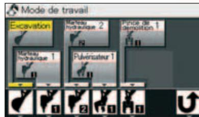
Lors d'un changement d'accessoire, le réglage du débit d'huile peut être effectué automatiquement par sélection du mode de travail sur l'écran LCD. Des réglages fins du débit d'huile sont possibles si nécessaire.
