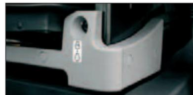
Levier d'arrêt de commande pilote
