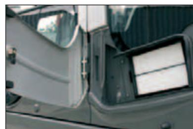
De larges portes permettent d'accéder depuis le sol au filtre de carburant, au séparateur d'eau et au filtre d'huile moteur. Une grande main courante et un marchepied équipé de plaques anti-dérapantes mènent au capot du moteur. Le carter d'huile moteur est muni d'un coupleur de vidange. Pour vidanger, il suffit de raccorder le flexible de vidange à ce coupleur. Le coupleur de vidange est fiable et évite les fuites d'huile et le vandalisme.
