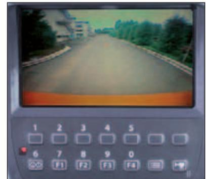
Le grand écran couleur à cristaux liquides, combiné à la caméra de surveillance de l'arrière placée sur le contrepoids, présente une vue de l'arrière.
