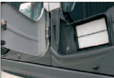
Le filtre d'air frais du climatiseur a été déplacé par rapport à l'emplacement conventionnel. Il se trouve maintenant du côté porte de la cabine, derrière le siège du conducteur. Le remplacement et le nettoyage du filtre d'air frais ainsi que du filtre de circulation d'air dans la cabine sont maintenant très faciles.
