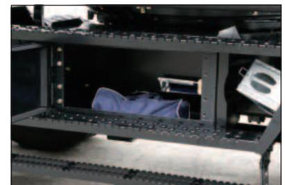
La machine est dotée d'un coffre à outils suffisamment spacieux pour ranger une caisse à outils. Le coffre peut être utilisé comme espace polyvalent de rangement d'outils et de pistolets de graissage.
