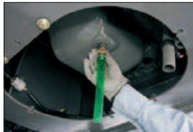
Le carter d'huile du moteur est équipé d'un coupleur pour la vidange. Pour vidanger, il suffit de raccorder le flexible de vidange à ce coupleur. Le coupleur de vidange est fiable et évite les fuites d'huile et le vandalisme.
