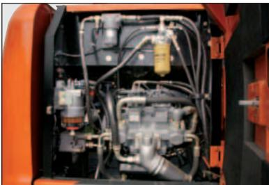
De grandes portes permettent, en restant au niveau du sol, d'accéder au filtre à carburant, au séparateur d'eau et au filtre à huile du moteur. L'huile hydraulique peut être employée jusqu'à 5 000 heures.
