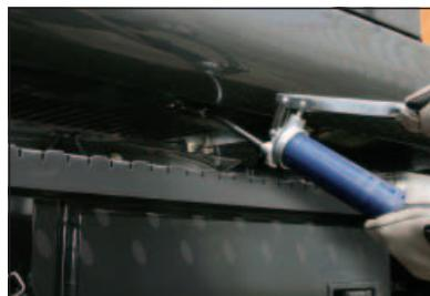
L'emplacement unique d'appoint en graisse du roulement de couronne a été repensé et est situé sous la cabine. Ceci permet d'améliorer le graissage et l'entretien.
