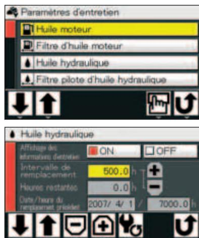
Le moniteur LCD alerte le conducteur sur la nécessité de changer l'huile hydraulique et les filtres à carburant selon le programme pré-établi par l'utilisateur à chaque fois qu'il tourne la clé de contact. L'entretien correctement programmé peut empêcher des dégâts sur l'équipement et une panne.
