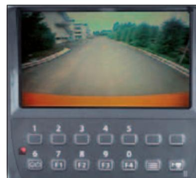
Le grand écran couleur LCD, combiné à la rétro-caméra sur le contrepois, fournit une vue pratique de la zone à l'arrière de l'engin.
