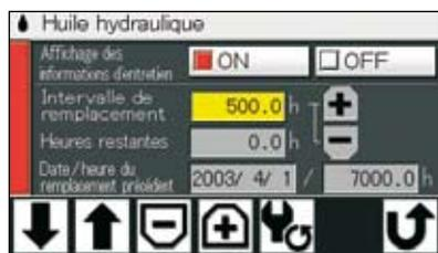
Le moniteur LCD alerte le conducteur sur la nécessité de changer l'huile hydraulique et les filtres à carburant selon le programme pré-établi par l'utilisateur à chaque fois qu'il tourne la clé de contact. La maintenance programmée peut éviter la panne de votre engin.
