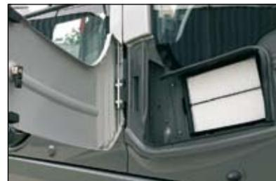
De grandes portes permettent, en restant au niveau sol, d'accéder au filtre à carburant, au séparateur d'eau et au filtre à huile du moteur. Une longue main courante et un marchepied pourvu de plaques anti-dérapantes mènent au couvercle du moteur. Le carter d'huile du moteur est équipé d'un coupleur pour la vidange. Pour vidanger, il suffit de raccorder le flexible de vidange à ce coupleur. Le coupleur de vidange est fiable et évite les fuites d'huile et le vandalisme.
